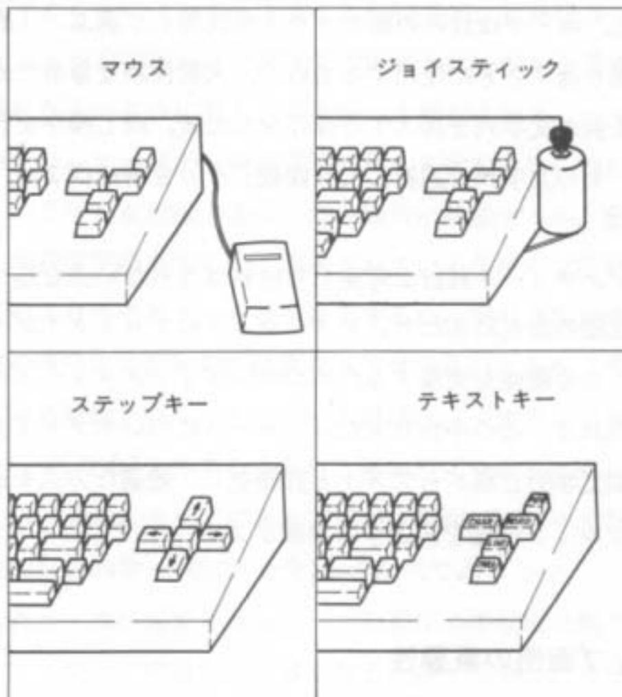
図 6.1 指示装置の概観
